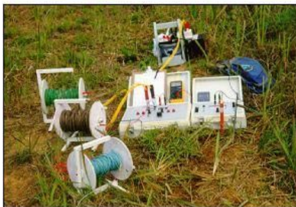
Figura 4.1. Exemplo de resistivímetro utilizado em campo. Extraído de CETESB, 1999.
